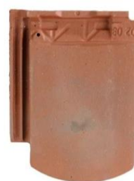
Tuile plate à emboitement, écaille Petit moule : dimensions courantes 23,5/32cm, 22 tuiles/m 2
