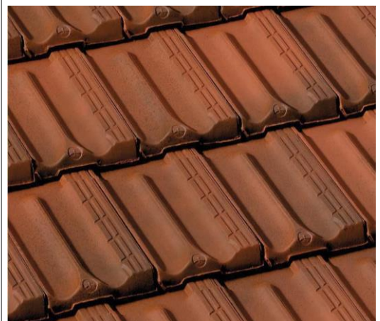
Tuile mécanique traditionnelle, à côte, (13 à 20 tuiles/m²). Dimensions courantes 21,5/35cm
