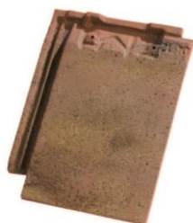
Tuile plate à emboitement, rectangulaire Petit moule : dimensions courantes 23,5/32cm, 22 tuiles/m 2
