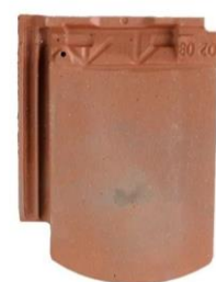
Tuile plate à emboitement, écaille Petit moule : dimensions courantes 23,5/32cm, 22 tuiles/m 2
