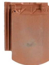
Tuile plate à emboîtement, écaille Petit moule : dimensions courantes 23,5/32cm, 22 tuiles/m 2
