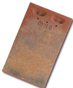
Tuile plate traditionnelle, rectangulaire Petit moule : dimensions courantes 17/27 cm, 60 tuiles/m 2
