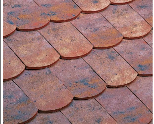
Tuiles plates à emboîtement, à petit moule, écailles (22 tuiles/m²). Dimensions courantes 23,5/32cm.
