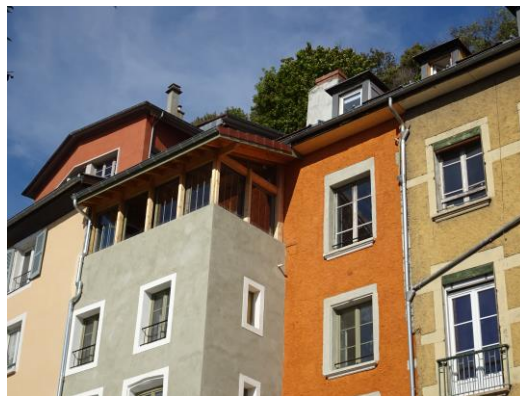
Surélévation traitée en structure légère, bois et métal vitrée sur toute la longueur. La toiture est restée identique. Grenoble (38)
